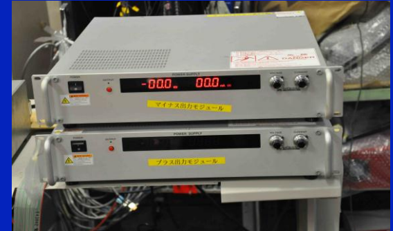
Power supply(-20kV, 40mA)
