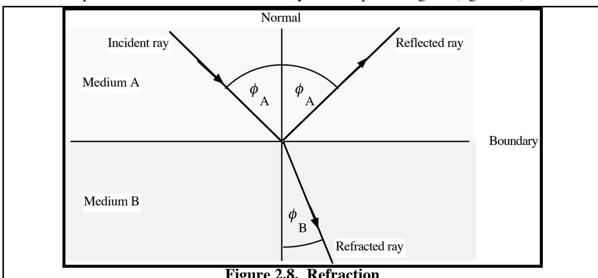
**Figure 2.8. Refraction**
